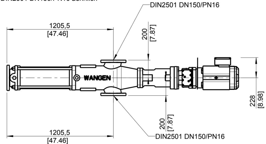
Es ist auf beiden Seiten der Pumpe 80cm freier Platz für Wartungsarbeiten vorzusehen. Sehen Sie über der Pumpe eine Vorbereitung für eine Hebevorrichtung (Last min. 250kg) vor.
